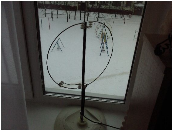
Кольцевая антенна на 2м. Периметр 0,5 \lambda
