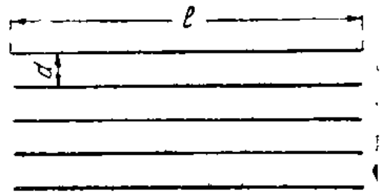
Рис. V. 3. 5. Система из нескольких параллельных проводов.
