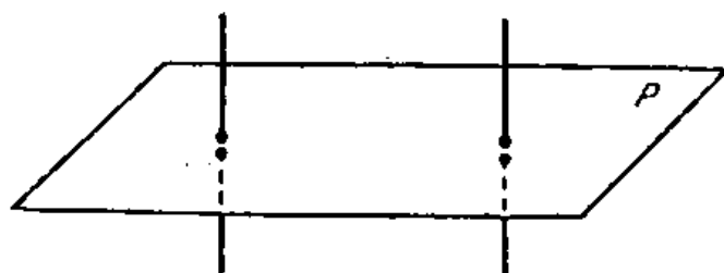
Рис. III. 8. 1. Пример системы из двух излучателей (симметричных вибраторов), не направленных в плоскости P , являющейся их экваториальной плоскостью.
