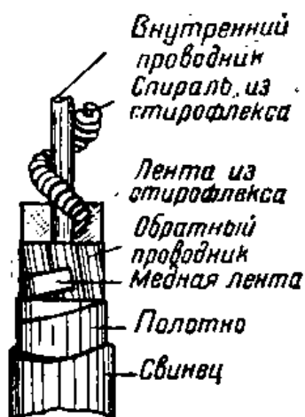
Рис VII. 10. 4. Однопроводный кордельный высокочастотный кабель.
