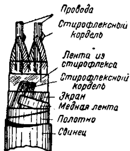
Рис. VII. 10. 5. Двухпроводный кордельный высокочастотный кабель.
