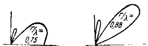
Рис. VI. 3. 14. Вертикальные характеристики направленности для цилиндрических антенн разных радиусов.
