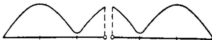
Рис. III. 2. 4. Распределение тока в симметричном вибраторе длиной 1,25 \lambda при учёте затухания (действующие значения).
