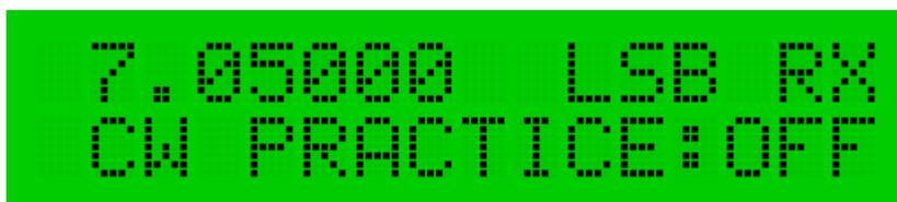
按 UP 和 DN 选择打开或关闭 CW 学习功能, 当选择 ON 时, CW 只有侧音而没有功率输出, 用于学习 CW,
