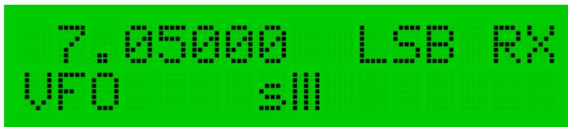
**界面定义：** LCD 上排显示的是机器当前工作频率，图中为 7.05000MHz。
