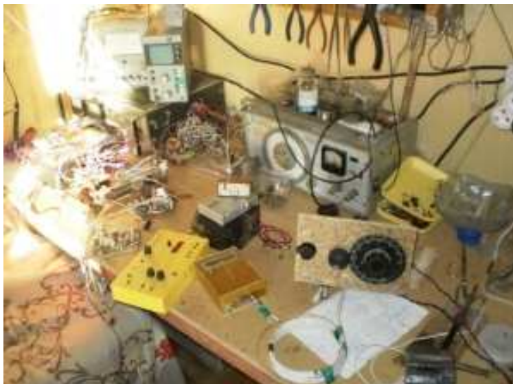
Фото 2. Самоделки на групповом фото. Можно заметить, что антенный анализатор меряет резонансную частоту небольшой бухточки кабеля, это подготовка к реализации антенны Владимира Тимофеевича под названием ВВП с кабельными отсекающими токи антенны
