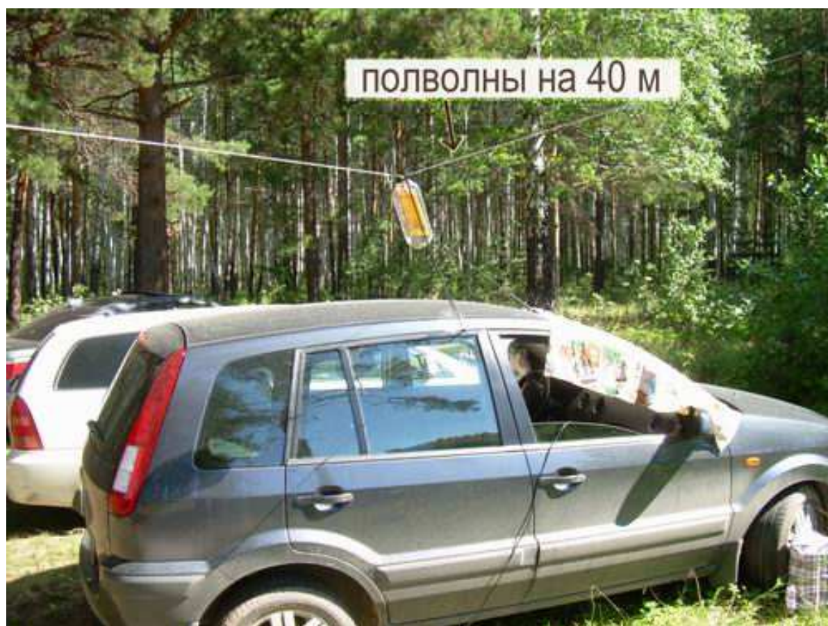
полуволновый вибратор с запиткой с конца через параллельный контур на 40м.
