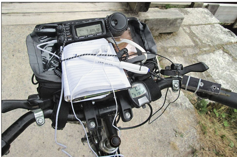
Obr.: Klíč je k řídítkům kola připevněn stahovacími pásky
