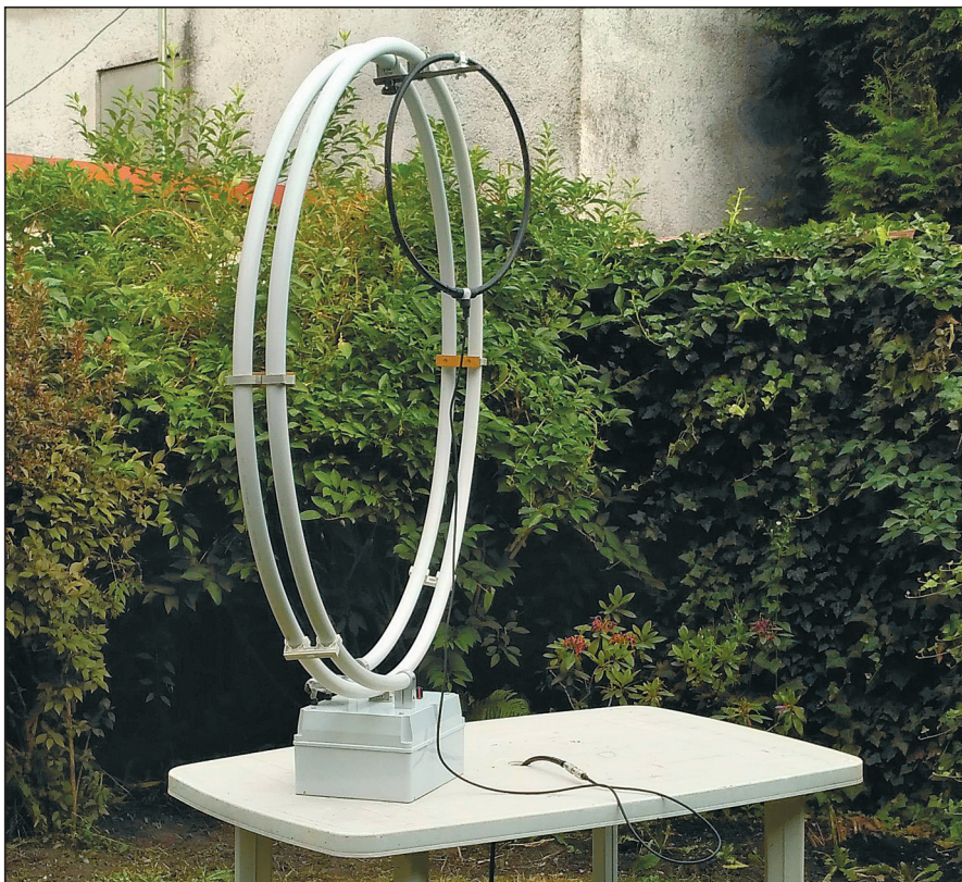
MLA-W magnetic loop antenna and a new way of its tuning by Olda, OK2ER Olda, OK2ER, zkouší anténu MLA-W s laděním nového typu
