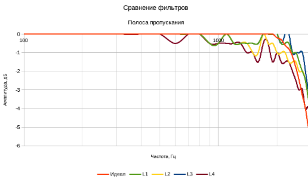
Рис. 8. АЧХ в полосе пропускания
