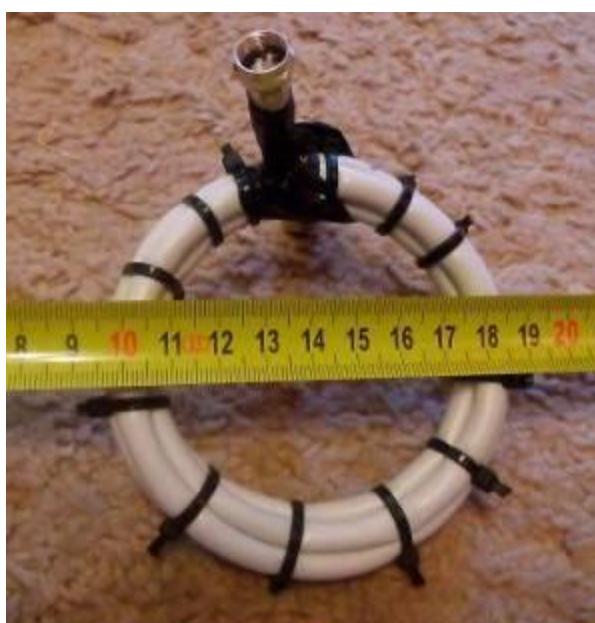
Рис. 1. Трап на 28 МГц, 4 витка.
