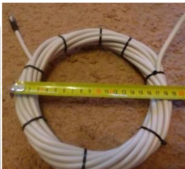
Рис. 8. Балун, расположен внизу антенны.
