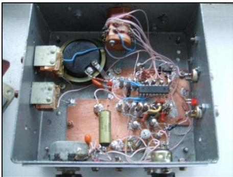
Для пайки микросхемы я использовал низковольтный паяльник, как и рекомендуется. Микросхему запаивал в последнюю очередь, когда всё остальное было установлено. Корпус моего ключа без художественных изысков. Использован подходящего размера металлический корпус. Главное для меня – это обеспечить механическую прочность
