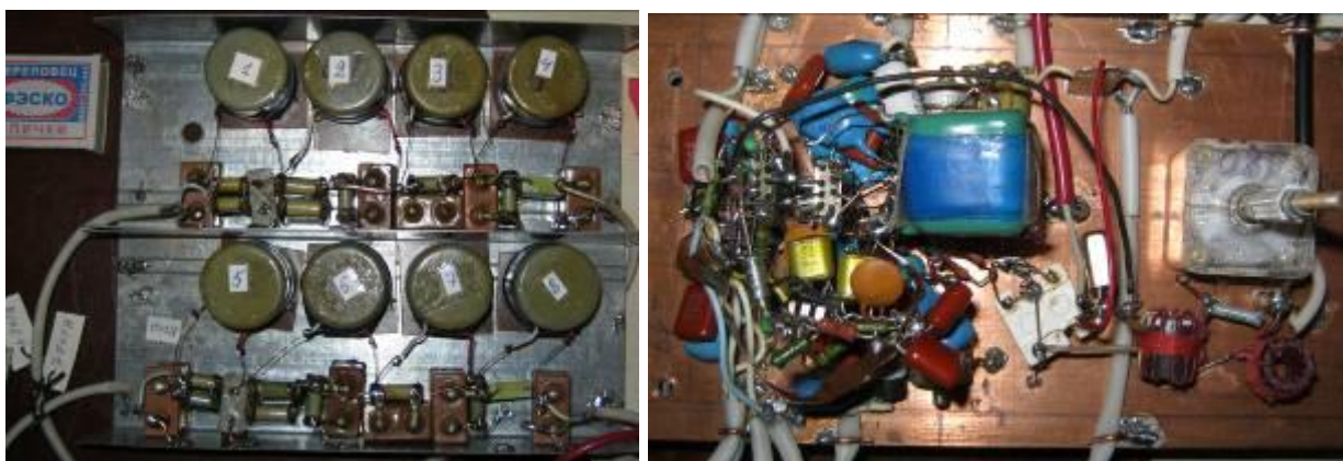
LC фильтры (слева), высокочастотный смеситель и ДПФ передающего тракта.
