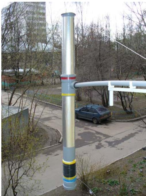
На фото - ЕН-антенны на 20 и на 80 м. Собственно ЕН-антенна представляет собой систему из двух цилиндров, катушки связи, основной и фазирующей катушек. Расчет параметров цилиндров и катушек хорошо производит программа Теда Харта [http://www.ehant.qrz.ru/ehantenna\\_r.xls](http://www.ehant.qrz.ru/ehantenna_r.xls). За основу конструкции моих антенн были взяты антенны
