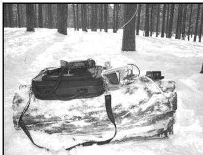
Аппарат работает отлично при отрицательных температурах, только валкодер и ручки вращаются туго, смазка густеет.
