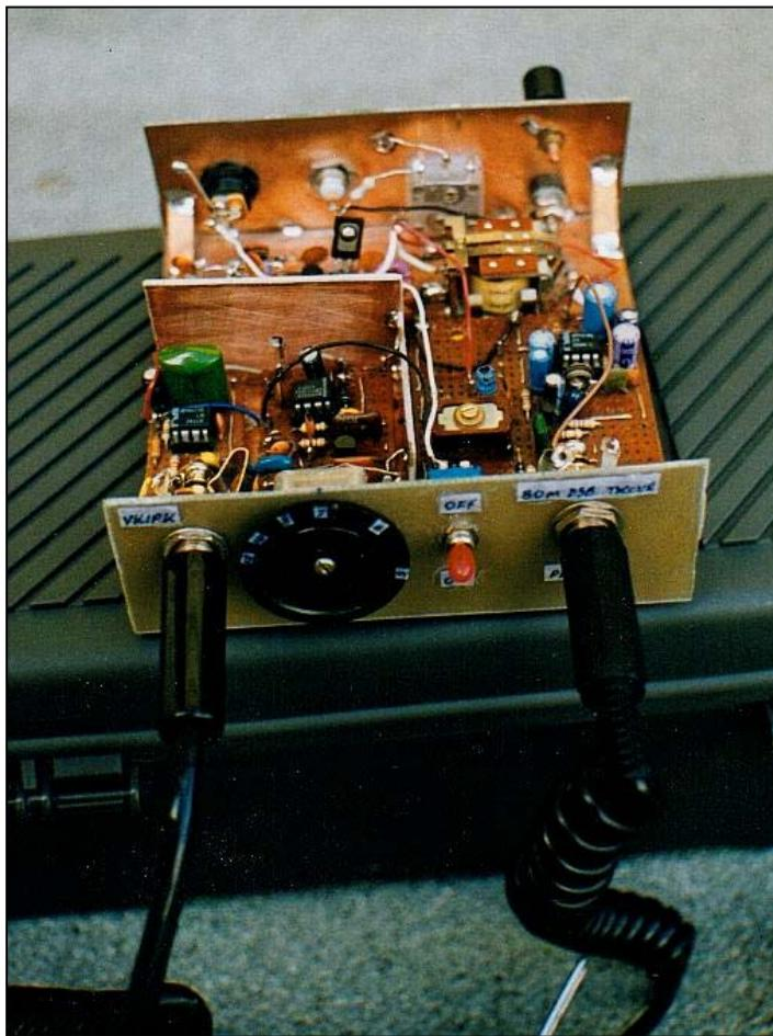
**DSB трансивер прямого преобразования на диапазон 80 метров с перестраиваемым ГПД**
