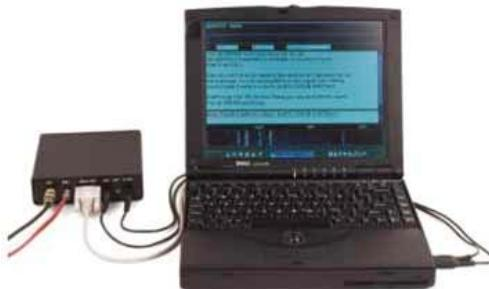
Для экспериментов мною был построен PSK микротрансивер на базе основного блока трансивера А. Темерева UR5VUL «Аматор-КФ-160» (журнал «Радио» № 3, 4 за 2002 год). Вместо ГПД я использовал VXO генератор с кварцем на
