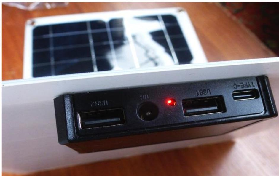
Чтобы получить доступ к плате, надо подцепить верхнюю крышку снизу в углах отвертками или чем то подобным и отжимать вверх, покачивая, пока крышка не сойдет со штифтов.
