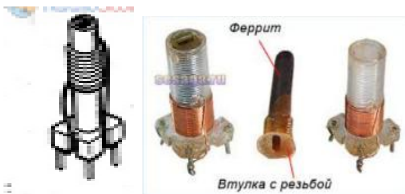
Рис. 2. Катушки приемника и подстроечный сердечник
