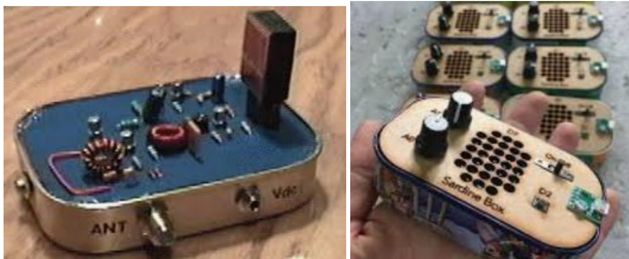
Рис. 4. Примеры конструкций в баночке из-под сардин, слева Тх, справа Rx.
