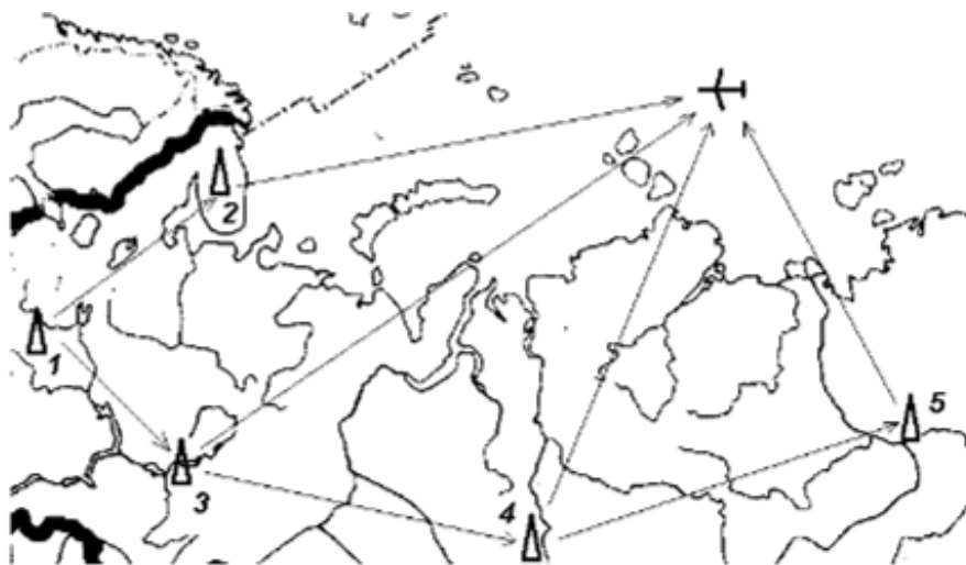
Рис. 7. Расположение ДВ станций. 1 – станция ГСВЧ, 2...5 – ведомые РВ.
