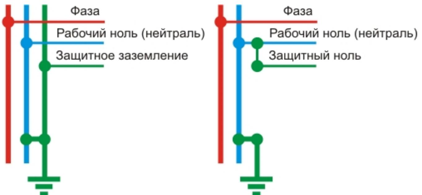
Рис. 4.5. Отличие защитного заземления и защитного "нуля"
