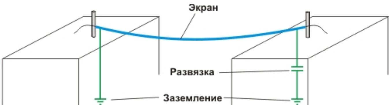
Рис. 4.9. Заземление экрана кабеля.
