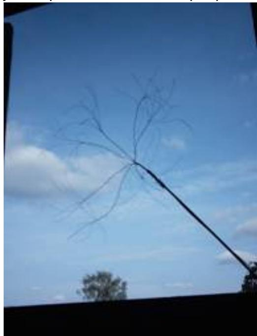
Рис. 1. Фрактально-метелочная антенна. Вид из люка на крышу.
